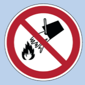
Verboden met water te blussen
